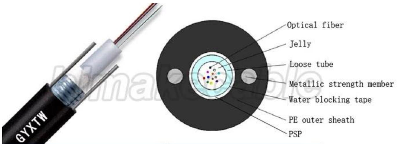
2 ~ 24 fibres, gelée remplie, fibre contenue tube central en vrac
